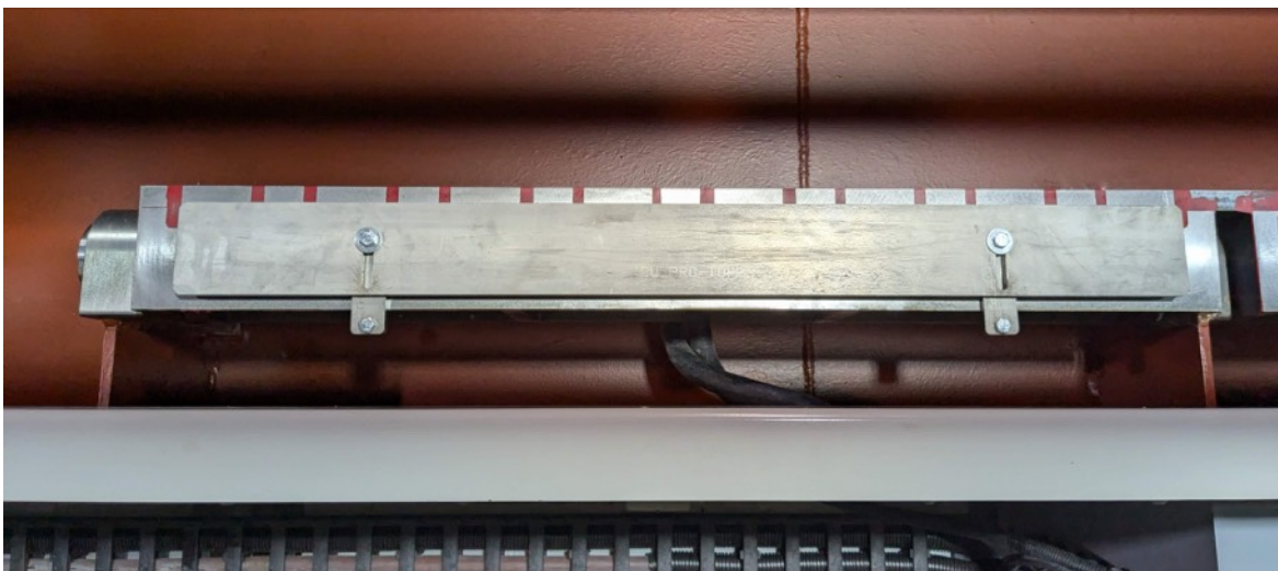
Tope centrador por la espalda de la cuchilla
